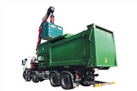
Véhicule ampliroll PAV
