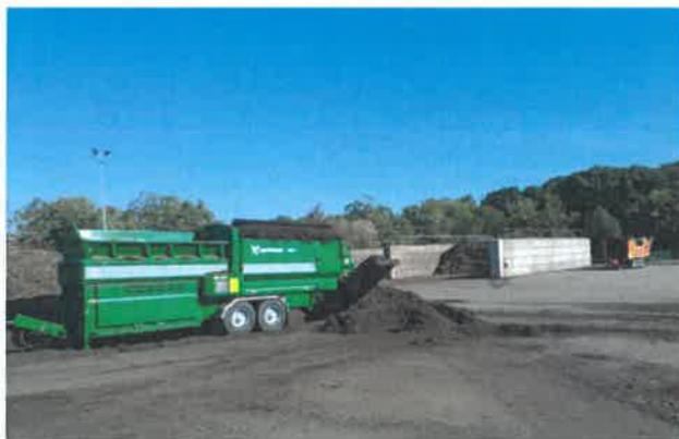
Les refus de criblage sont soit rebroyés pour reprendre le cycle de compostage, soit utilisés comme structurant pour le compostage des boues sur le site des Amendements Nivernais à La Machine (58).
