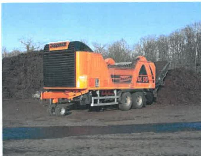
Nous effectuons une opération de broyage toutes les 300 tonnes de déchets bruts réceptionnés. Une fois broyés, les déchets verts sont placés dans des casiers en aération forcée et arrosée.
