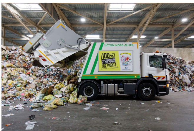
Vidage d'une BOM dans le hall réception
